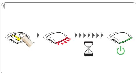
4 Maschine durch Bewegen des Dosierungsschiebers einschalten. Während die Maschine ca. 40 Sekunden lang aufheizt, blinkt die Anzeigelampe rot. Anschließend leuchtet die Anzeigelampe grün. Die Maschine ist bereit.
