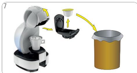
Arretierbügel öffnen. Kapselhalter herausziehen. Kapselhalter öffnen. Gebrauchte Kapsel entfernen. Gebrauchte Kapsel in den Abfallbehälter geben. Unbedingt darauf achten, den Kapselhalter nicht wegzuerwerfen.
