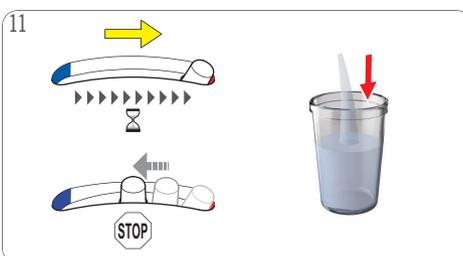
Wahlhebel in Position für "HEISS" bewegen. Abwarten, bis sich der Hebel in die Position "Stopp" zurückbewegt. Das Wasser stoppt.
