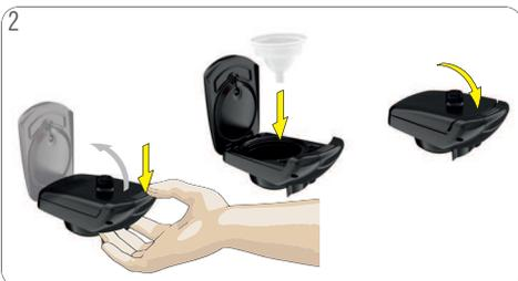
2 Verriegelungslasche des Kapselhalters drücken, um Kapselhalter herauszuziehen und zu öffnen. Sicherstellen, dass der Spüleinsatz im Kapselhalter sitzt. Kapselhalter schließen.
