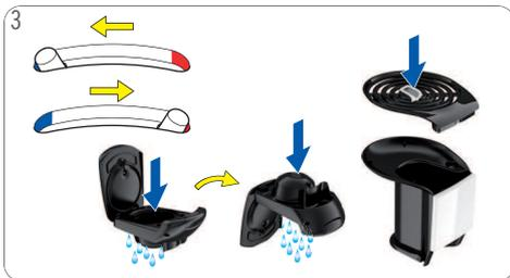
3 Maschine spülen: Anweisungen in 5. „ERSTE INBETRIEBNAHME“ auf Seite 9 befolgen. Kapselhalter auf beiden Seiten mit Spülmittel und Wasser reinigen. Abtropfschale mit Wasser abspülen und mit einer Bürste reinigen.
