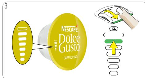
Mit dem Dosierungsschieber auf der Dosierungsanzeige die gewünschte Anzahl Leucht balken entsprechend den Angaben auf der Kapsel oder nach eigenem Geschmack auswählen. Für extragroße Tasse XL wählen. Warten Sie ca. 1,5 Minuten ab, wenn Sie eine zweite extragroße Tasse zubereiten möchten.
