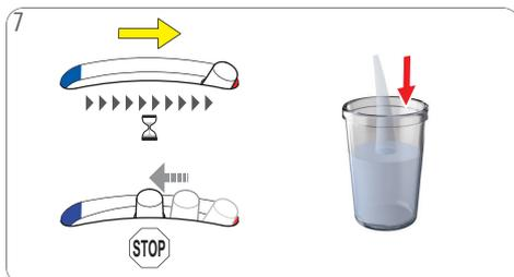
Wahlhebel in Position für "HEISS" bewegen. Der Entkalkungsvorgang dauert ca. 2 Minuten. Dabei startet und stoppt die Maschine mehrfach. Wahlhebel bewegt sich in die Mitte zurück.
