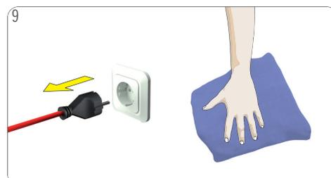
Maschine ausstecken! Maschine mit einem weichen, feuchten Tuch reinigen. Anschließend mit einem weichen Tuch trocknen.
