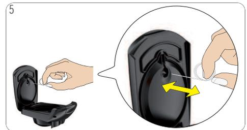
5 Kapselhalter öffnen und Düse mit Reinigungsnadel reinigen. Anweisungen in 8. „Entkalkung alle 3 – 4 Monate“ auf Seite 14 befolgen.
