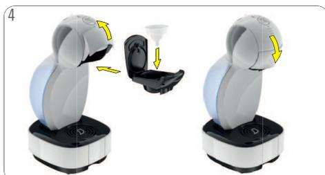
Arretierungsbügel öffnen. Spüleinsatz in Kapselhalter einsetzen. Kapselhalter in die Maschine einführen. Arretierungsbügel schließen.
