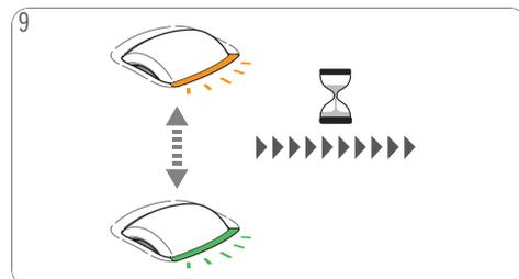
Damit die Entkalklerlösung besser wirken kann, wartet die Maschine zunächst 2 Minuten ab. Die Leuchtballen erlöschen der Reihe nach.
