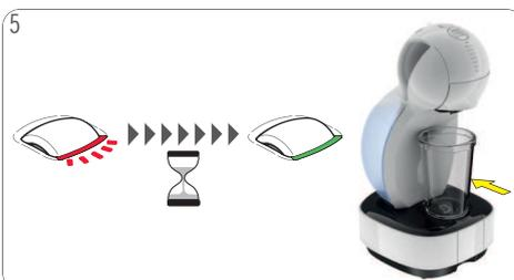
Maschine schaltet sich automatisch ein. Während die Maschine ca. 40 Sekunden lang aufheizt, blinkt die Anzeigelampe rot. Anschließend leuchtet die Anzeigelampe grün. Die Maschine ist bereit. Großen, leeren Behälter unter den Getränkeauslass stellen.
