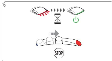
6 Abwarten, bis das Wasser stoppt. Die Anzeigelampe blinkt einige Sekunden lang rot und wechselt dann zu grün. Wahlhebel bewegt sich in die Position "Stopp" zurück.
