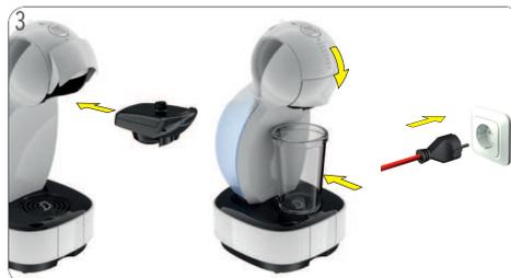
3 Kapselhalter in die Maschine einführen. Arretierungsbügel schließen. Großen, leeren Behälter unter den Getränkeauslass stellen. Sicherstellen, dass die korrekte Netzspannung verwendet wird, siehe 2. „ÜBERSICHT“ auf Seite 5. Netzstecker in Steckdose stecken.
