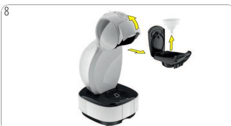
Arretierungsbügel öffnen. Kapselhalter herausziehen. Spüleinsatz entfernen. Bewahren Sie sie an einem sicheren Ort auf, damit sie später bei der Reinigung oder Entkalkung zur Verfügung steht. Wasserbehälter ggf. entleeren.
