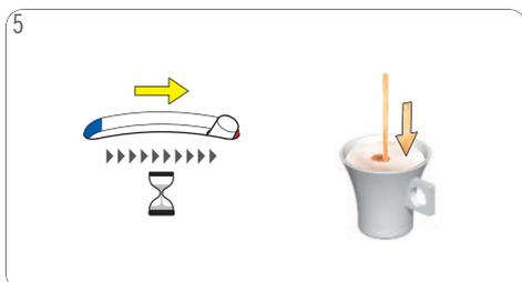
Wahlhebel, wie auf der Kapselverpackung angegeben, in Position für "HEISS" oder "KALT" bewegen. Die Getränkezubereitung beginnt. Abwarten, bis die Maschine stoppt. Die Getränkezubereitung kann jederzeit manuell unterbrochen werden, indem Sie den Hebel zurück in die Position "STOPP" bewegen.
