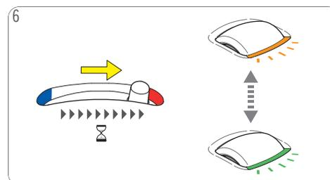
6 Wahlhebel in Position "Heiß" schieben und 10 Sekunden lang in dieser Position halten. Die Leuchtbarren erlöschen der Reihe nach.
