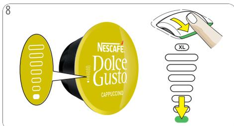
Mit dem Dosierungsschieber auf der Dosierungsanzeige die gewünschte Anzahl Leucht balken entsprechend den Angaben auf der Kapsel oder nach eigenem Geschmack auswählen.
