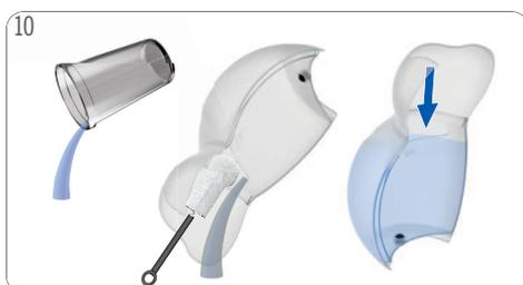
Behälter leeren und reinigen. Wasserbehälter spülen und reinigen. Bei Bedarf eine Bürste und Spülmittel verwenden. Anschliessend mit frischem Trinkwasser füllen und in die Maschine einsetzen.
