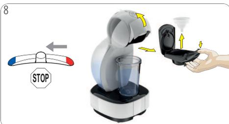
8 Abwarten, bis sich der Hebel in die Position "Stopp" zurückbewegt. Arretierungsbügel öffnen. Kapselhalter herausziehen. Kapselhalter öffnen. Spüleinsatz entfernen. Bewahren Sie sie an einem sicheren Ort auf, damit sie später bei der Reinigung oder Entkalkung zur Verfügung steht. Kapselhalter wieder einsetzen.
