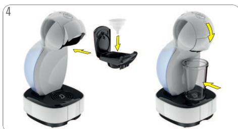
4 Arretierungsbügel öffnen. Spüleinsatz in Kapselhalter einsetzen. Kapselhalter in die Maschine einführen. Arretierungsbügel schließen. Großen, leeren Behälter unter den Getränkeauslass stellen.
