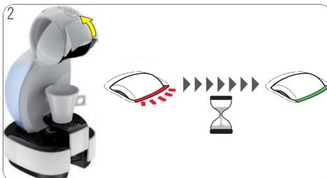
Arretierungsbügel öffnen. Kapselhalter herausziehen. Maschine schaltet sich automatisch ein. Während die Maschine ca. 40 Sekunden lang aufheizt, blinkt die Anzeileuchte rot. Anschließend leuchtet die Anzeileuchte grün. Die Maschine ist bereit.
