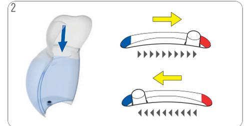
Prüfen, ob der Wasserbehälter ausreichend frisches Trinkwasser enthält. Wenn nein, Wasserbehälter auffüllen und Wahlhebel wieder in Position "HEISS" bzw. "KALT" bewegen, um mit der Zubereitung fortzufahren. Wenn der Wasserbehälter voll ist, wie in „WENN KEINE FLÜSSIGKEIT HERAUSFLIESST – KAPSEL / DÜSE BLOCKIERT“ auf Seite 17 beschrieben vorgehen.
