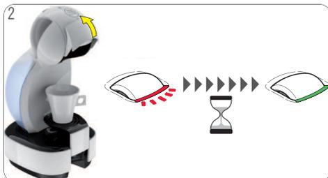
Arretierbügel öffnen. Kapselhalter herausziehen. Maschine schaltet sich automatisch ein. Während die Maschine ca. 40 Sekunden lang aufheizt, blinkt die Anzeileuchte rot. Anschließend leuchtet die Anzeileuchte grün. Die Maschine ist bereit.
