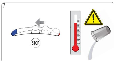
Abwarten, bis sich der Hebel in die Position "Stopp" zurückbewegt. Das Wasser stoppt. Behälter leeren und reinigen. **Achtung: Heißes Wasser! Vorsichtig vorgehen!**
