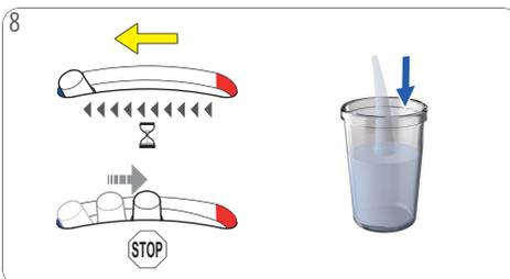
Wahlhebel in Position für "KALT" bewegen. Die Maschine führt den Entkalkungsvorgang nun kontinuierlich durch. Wahlhebel bewegt sich in die Mitte zurück.
