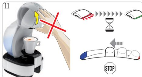
Nach Abschluss der Zubereitung blinkt die Anzei­geleuchte einige Sekunden lang rot und wechselt dann zu grün. Wahlhebel bewegt sich in die Position "Stopp" zurück. **Währenddessen darf der Arretierungsbügel nicht geöffnet werden!**
