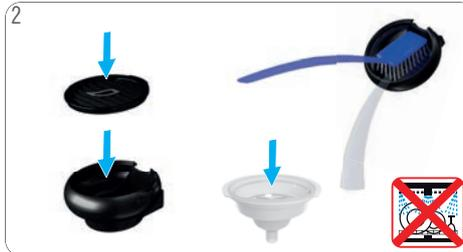
Abtropfgitter und Spüleinsatz mit Wasser spülen und Abtropfgitter mit einer Bürste und Spülmittel reinigen. Diese Teile sind nicht spülmaschinenfest!
