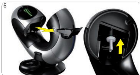
Kapselhalter entnehmen. Düse-Werkzeug auf die Düse setzen.
