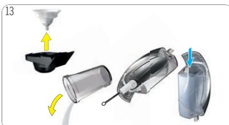
13 Kapselhalter herausziehen. Spüleinsatz entfernen. Kapselhalter auf beiden Seiten mit Wasser abspülen. Kapselhalter wieder einsetzen. Behälter leeren und reinigen. Wasserbehälter spülen und reinigen. Anschliessend mit frischem Trinkwasser füllen und in die Maschine einsetzen.
