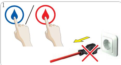
Maschine nicht kippen oder auf den Kopf stellen! Um die Zubereitung zu unterbrechen, Heiß-/Kaltwassersymbol erneut antippen. Netzstecker nicht aus der Steckdose ziehen! Die Maschine baut den Druck ab.
