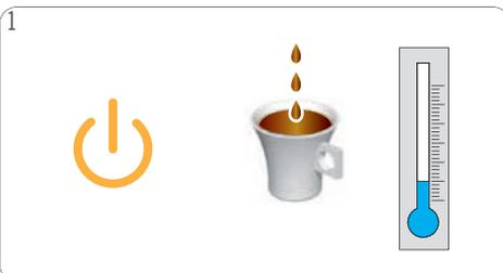
1 Wenn das Getränk langsamer als üblich herausläuft (evtl. sogar nur tropfenweise) oder kühler als üblich ist oder der Netzschalter kontinuierlich orange leuchtet (Entkalkungsanzeige), muss die Maschine entkalkt werden.
