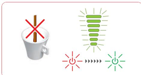
Es fließt keine Flüssigkeit heraus: Die Getränkezubereitung wird während des Vorgangs unterbrochen oder beginnt erst gar nicht. Die Leuchtbalkeanzeige blinkt. Der Netzschalter blinkt rasch (abwechselnd rot und grün).
