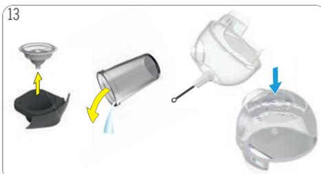
Kapselhalter herausziehen. Spüleinsetz entfernen. Kapselhalter auf beiden Seiten mit Wasser abspülen. Kapselhalter wieder einsetzen. Behälter leeren und reinigen. Wasserbehälter spülen und reinigen. Anschliessend mit frischem Trinkwasser füllen und in die Maschine einsetzen.
