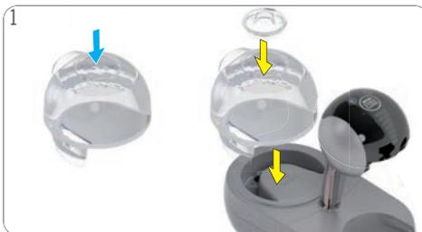
1 Wasserbehälter manuell mit Wasser spülen. Wasserbehälter mit frischem Trinkwasser füllen. Kappe schließen und Wasserbehälter in Maschine einsetzen.
