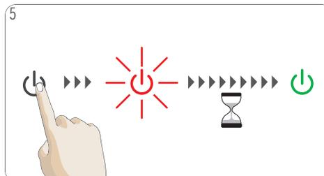
Maschine einschalten. Während die Maschine ca. 40 Sekunden lang aufheizt, blinkt der Netzschalter rot. Anschließend leuchtet der Netzschalter grün. Die Maschine ist bereit.
