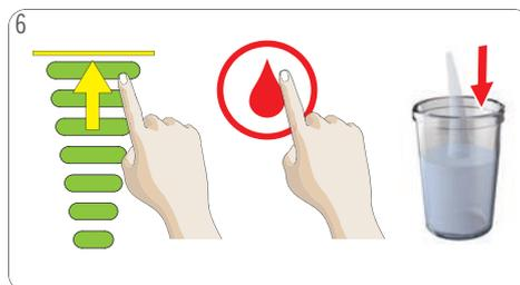
6 Dann mit heißem Wasser spülen: Leuchtbalkeanzeige durch Berührung mit dem Finger auf Maximum stellen. Heißwassersymbol antippen. Die Maschine beginnt zu spülen. Die Leuchtbalke erlöschen der Reihe nach.
