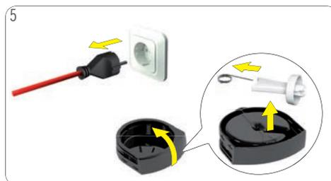
Maschine ausstecken! Abtropfschale herumdrehen. Düse-Werkzeug herausnehmen. Reinigungsnadel aus dem Düse-Werkzeug herausziehen. **Nadel darf nicht in die Hände von Kindern gelangen!**
