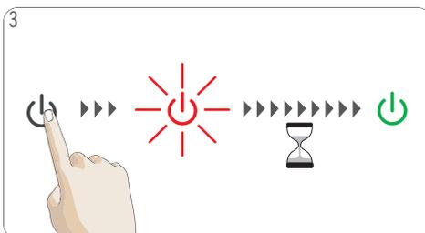
3 Maschine einschalten. Während die Maschine ca. 40 Sekunden lang aufheizt, blinkt der Netzschalter rot. Anschließend leuchtet der Netzschalter grün. Die Maschine ist bereit.
