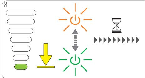
Damit die Entkalkerlösung besser wirken kann, wartet die Maschine zunächst 2 Minuten ab. Während dieser Zeit blinkt der Netzschalter abwechselnd grün und orange.
