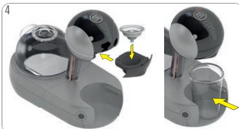
Spüleinsatz in Kapselhalter einsetzen. Kapselhalter in die Maschine einführen. Abtropfgitter und Abtropfschale entfernen. Großen, leeren Behälter unter den Getränkeauslass stellen.
