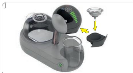
1 Spüleinsatz in Kapselhalter einsetzen. Kapselhalter in die Maschine einführen.
