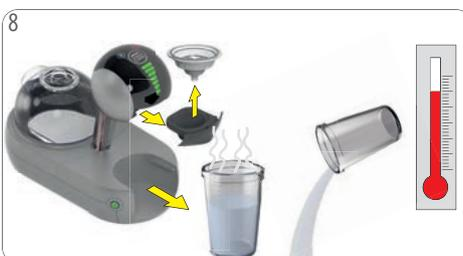
8 Kapselhalter herausziehen. Spüleinsetz entfernen. Kapselhalter wieder einsetzen. Behälter entfernen. **Achtung: Heißes Wasser! Vorsichtig vorgehen!** Behälter leeren.
