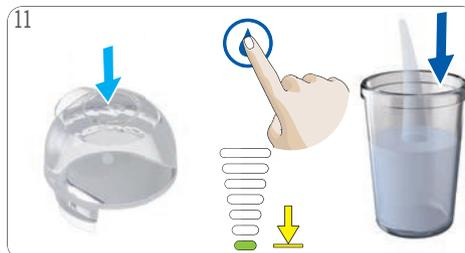
Wasserbehälter mit frischem Trinkwasser füllen. Kaltwassersymbol antippen. Die Leuchtballen erlöschen der Reihe nach. Abwarten, bis die Maschine stoppt.
