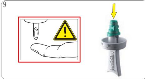
Düse auf das Düse-Werkzeug setzen.
