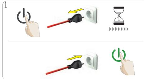
1 Maschine ausschalten. Überprüfen, ob die Kapsel blockiert ist (siehe „WENN KEINE FLÜSSIGKEIT HERAUSFLIESST – KAPSEL / DÜSE BLOCKIERT“ auf Seite 16). Netzstecker ausstecken und 20 Minuten warten. Netzstecker wieder in die Steckdose stecken und Maschine einschalten.
