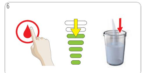
6 Heißwassersymbol antippen. Die Leuchtbalken erlöschen der Reihe nach. Der Entkalkungsvorgang dauert ca. 2 Minuten. Dabei startet und stoppt die Maschine mehrfach. Abwarten, bis die Maschine stoppt.
