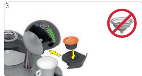
Kapselhalter herausziehen. Sicherstellen, dass der Spülein-satz nicht eingesetzt ist. Kapsel in den Kapselhalter stecken. Kapselhalter in die Maschine einführen.
