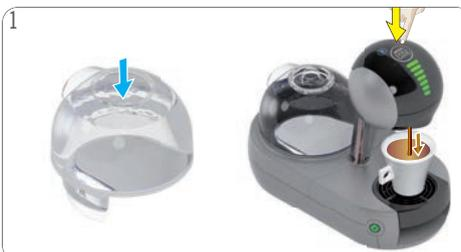
Prüfen, ob der Wasserbehälter ausreichend frisches Trinkwasser enthält. Wenn nicht, dann Wasserbehälter mit frischem Trinkwasser auffüllen und Heiß-/Kaltwassersymbol erneut antippen, um mit der Zubereitung fortzufahren. Wenn der Wasserbehälter voll ist, wie in „WENN KEINE FLÜSSIGKEIT HERAUSFLIESST – KAPSEL / DÜSE BLOCKIERT“ auf Seite 16 beschrieben vorgehen.
