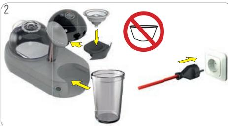
2 Sicherstellen, dass der Spüleinsetz im Kapselhalter sitzt und der Kapselhalter in die Maschine eingesetzt ist. Großen, leeren Behälter unter den Getränkeauslass stellen. Sicherstellen, dass die korrekte Netzspannung verwendet wird, siehe 2. „ÜBERSICHT“ auf Seite 5. Netzstecker in Steckdose stecken.
