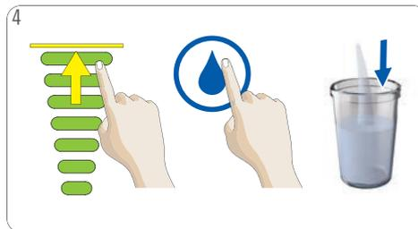
4 Zuerst mit kaltem Wasser spülen. Leuchtbalkeanzeige durch Berührung mit dem Finger auf Maximum stellen. Kaltwassersymbol antippen. Die Maschine beginnt zu spülen. Die Leuchtbalke erlöschen der Reihe nach.
