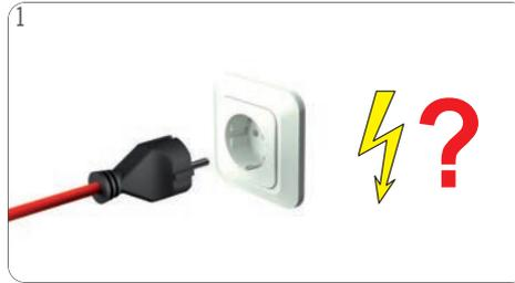
1 Überprüfen, ob der Netzstecker ordnungsgemäß in eine Steckdose eingesteckt ist. Wenn ja, Stromversorgung überprüfen.
