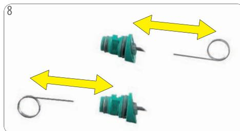
Reinigungsnadel in die Düse einführen und Düse reinigen. Sollte das nicht möglich sein, mit dem Inhalt eines Entkalkerbeutels und 0,5 Liter frischem Trinkwasser Entkalkerlösung herstellen. Düse in Entkalkerlösung legen.
