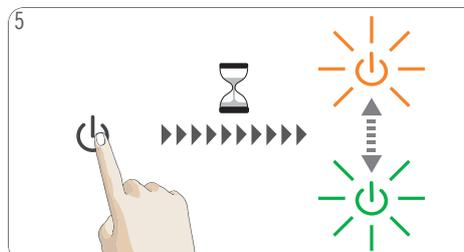
5 Netzschalter drücken und mindestens 5 Sekunden gedrückt halten. Der Netzschalter beginnt abwechselnd grün und orange zu blinken, und die Maschine wechselt in den Entkalkungsmodus.
