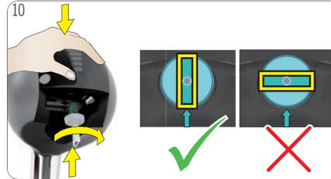
Düse von unten in die Öffnung der Maschine einführen. Düse mit der Hand abstützen. Düse im Uhrzeigersinn drehen, bis sie wieder fest in ihrer Position sitzt. Anweisungen in 8. „Entkalkung alle 3 – 4 Monate“ auf Seite 13 befolgen.
